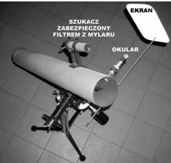
Stanowisko do obserwacji Słońca metodą projekcyjną (fot. Dominik Pasternak)
