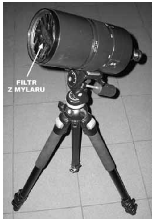
Teleskop z zamocowanym filtrem z folii mylarowej (fot. Dominik Pasternak)
