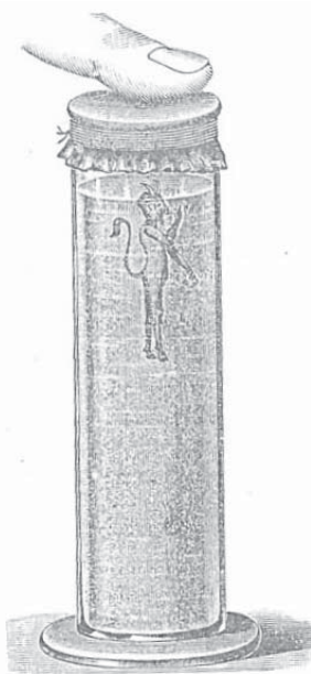
Rys. 7. Nurek Kartezjusza zwany diabełkiem weneckim Źródło: H. Maser, P. Richert, A. Kühns, „Die Physik”, Verlag von J. Neumann, Berlin 1905.
