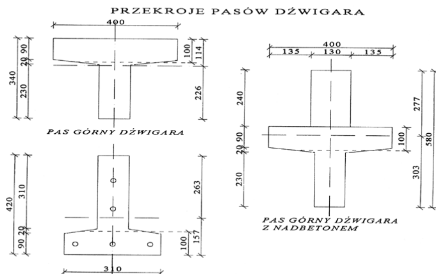
Rys. 6. Charakterystyka geometryczna dźwigara KBOS-24
