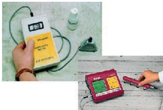
Rys. 1. Pomiar w praktyce oporności betonu metodą Wennera [12, 13]
