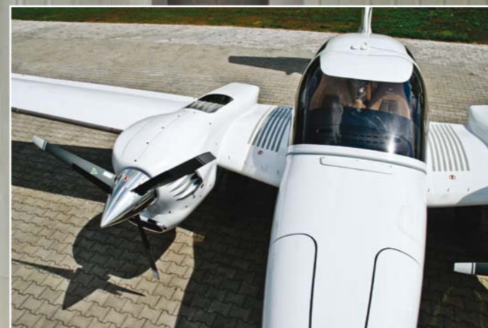
Zdjęcia w tle: Charakterystyczna gondola silnika i trółopatowe, stałobrotowe śmigło MT-6. Kontrola silnika przed startem ogranicza się do wciśnięcia jednego przycisku.
