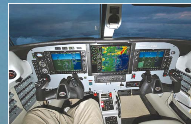
Zdjęcie po lewej: choć kabina wydaje się relatywnie wąska we wnętrzu zagospodarowano miejsce na sześć foteli. Zdjęcie po prawej: trzy ekrany Garmina G1000, w tym największy w tej klasie samolotów centralny ekran MFD.
