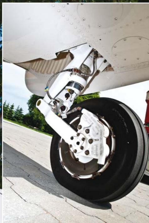
Zdjęcie na górze: Solidna, chowana goleń podwozia głównego. Musi znieść przyzie- mienie przy masie do 4,2 tony.
