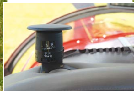
Nad tablicą przyrządów dwie busole - dla lewego i prawego fotela.
