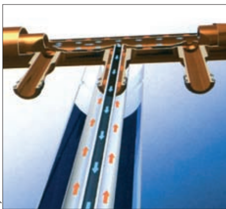
Rys. 4 Próżniowy rurowy kolektor słoneczny z przepływem bezpośrednim
