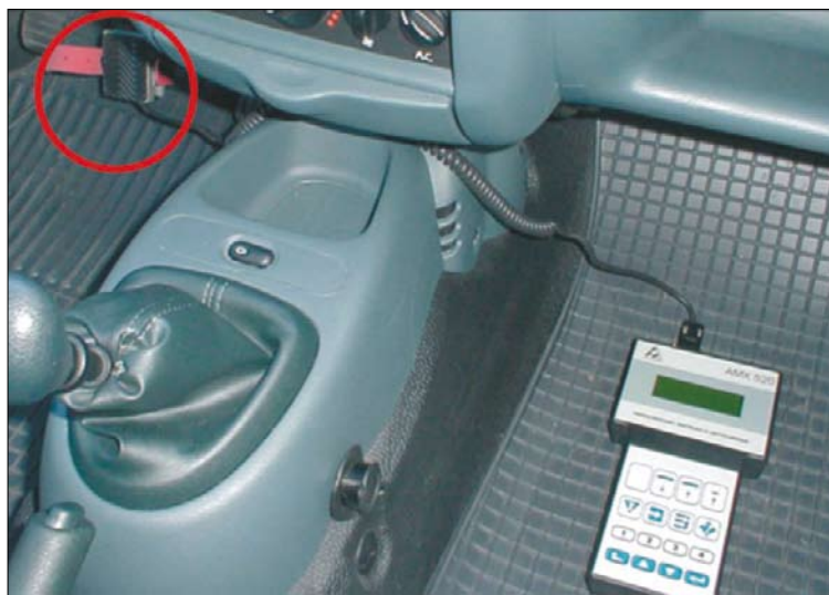
Przykładowe umiejscowienie opóźnieniomierza w samochodzie podczas badań (Źródło: Automex)
