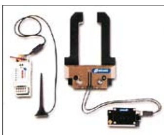
Rys. 9. Bezprzewodowy system czujników EnOcean zainstalowany przez firmę SCHUNK
