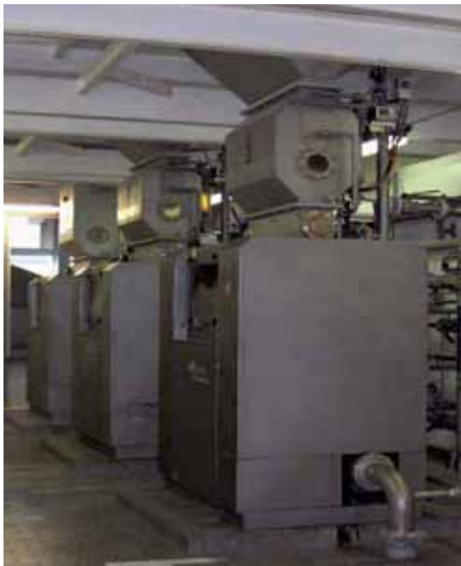
Rys. 2. Śrutowniki pracujące przy rozdrabnianiu słodu w warzelni piwa.
