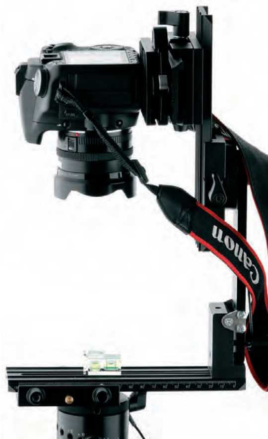
Weryfikacja położenia osi optycznej obiektywu względem pionowej osi obrotu i weryfikacja prawidłowego przykręcenia aparatu do płytki szybko mocującej. Oś optyczna i pionowa oś obrotu muszą się pokrywać. Ustawienie sprawdzamy w dwóch płaszczyznach – od przodu i z boku.
