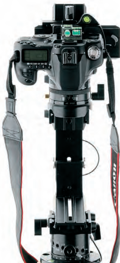
Weryfikacja położenia osi optycznej obiektywu względem pionowej osi obrotu i weryfikacja prawidłowego przykręcenia aparatu do płytki szybko mocującej. Oś optyczna i pionowa oś obrotu muszą się pokrywać. Ustawienie sprawdzamy w dwóch płaszczyznach – od przodu i z boku.
